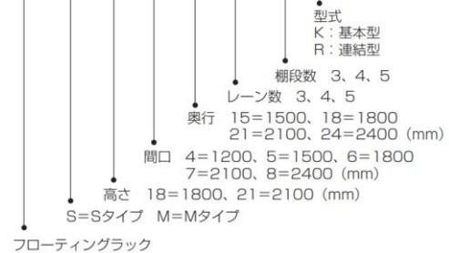
Sタイプ 最大積載質量 (等分布载荷) 300kg/段
