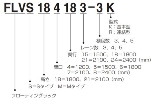
Sタイプ 最大積載質量 (等分布载荷) 300kg/段
