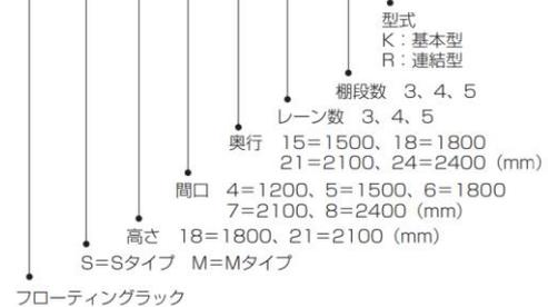
Sタイプ 最大積載質量 (等分布载荷) 400kg/段
