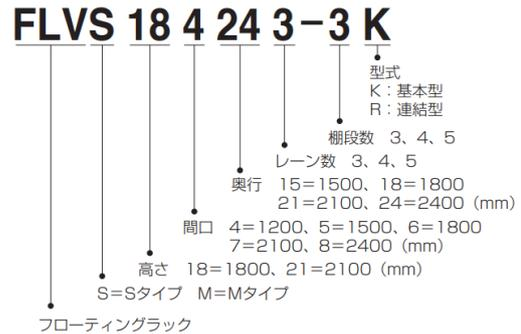
Sタイプ 最大積載質量 (等分布载荷) 400kg/段
