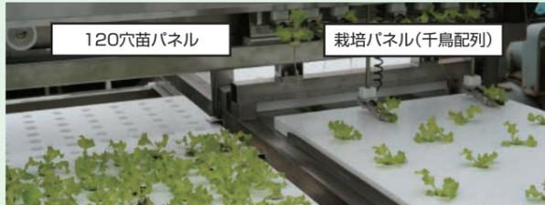
左右に移動する間にフィンガーの間隔を調整し、千鳥配列が可能に!
