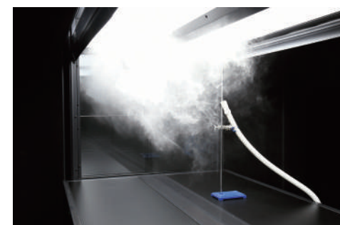
独自の気流制御による有汚染空気の実証的な捕捉
