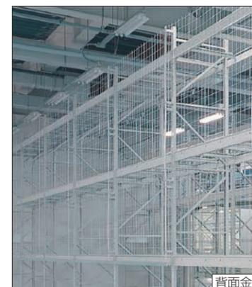
側面や背面からの荷物の落下を防ぎ、作業者のけがや収納物の散乱、破損を防ぎます。
