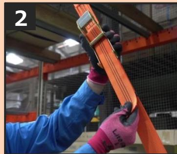
2 センターバックルを持ちながらベルトを引いてテンションを調整します。
